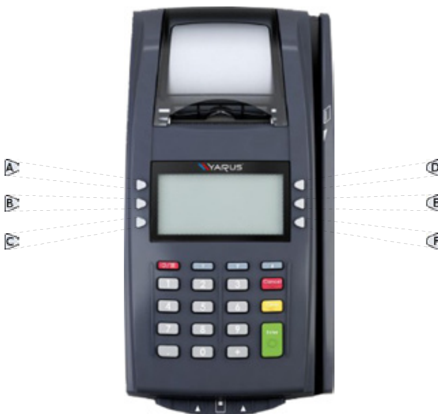
Рис. 3.1. Условные обозначения боковых кнопок С2100.
