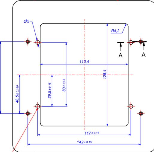
Опора для кнопок Безопасности
